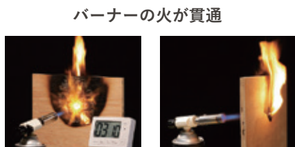
炎を出して燃えている バーナーの火が貫通
